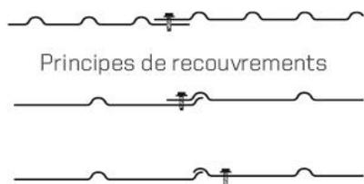
Principes de recouvrements
