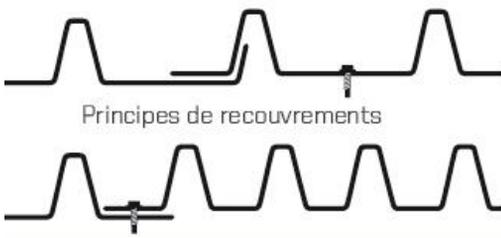
Principes de recouvrements
